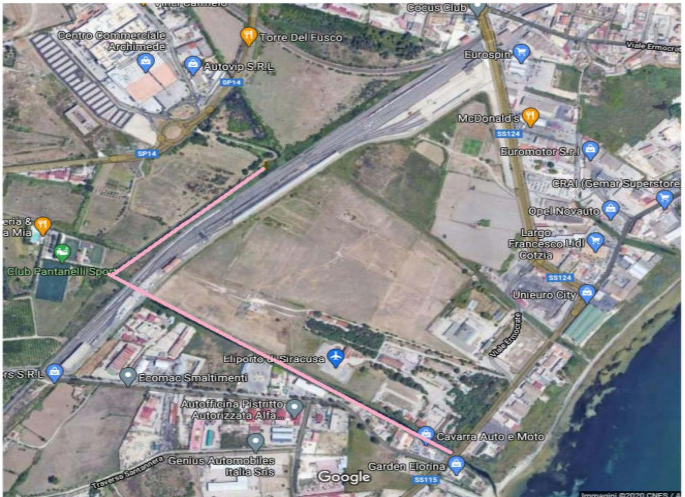
Il nuovo allacciante Pantanelli si unisce al vecchio Pantanelli in prossimità dell'attraversamento ferroviario con un brusco cambio di sezione grazie alla realizzazione di una curva con raggio pari a 30 m circa .
